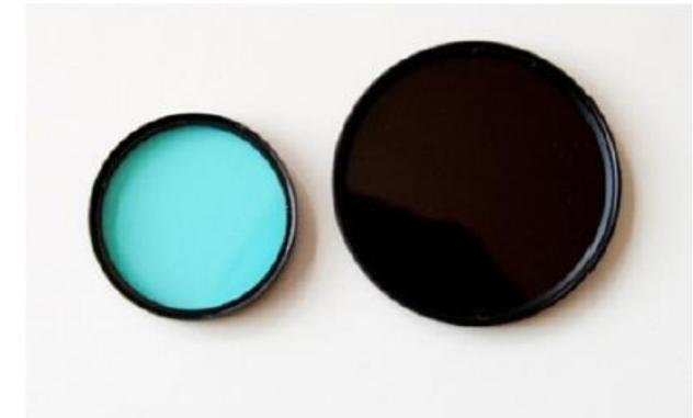
(a) Ejemplo de dos espectros de transmisión para los típicos filtros de bloqueo de infrarrojos utilizados en cámaras. (b) Transmisión típica de filtros de transmisión NIR, es decir, filtros de bloqueo VIS. (c) Filtros de bloqueo VIS (izquierda) y de bloqueo NIR (Izquierda)
